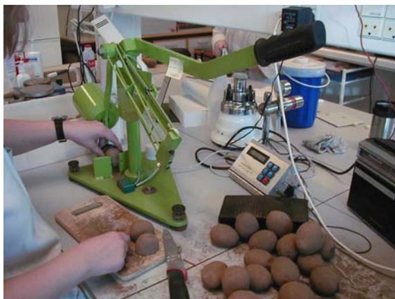
Figur 1. Billede af slagpendulet MIDAS 95P, Argus electronic, Rostock, Tyskland.
