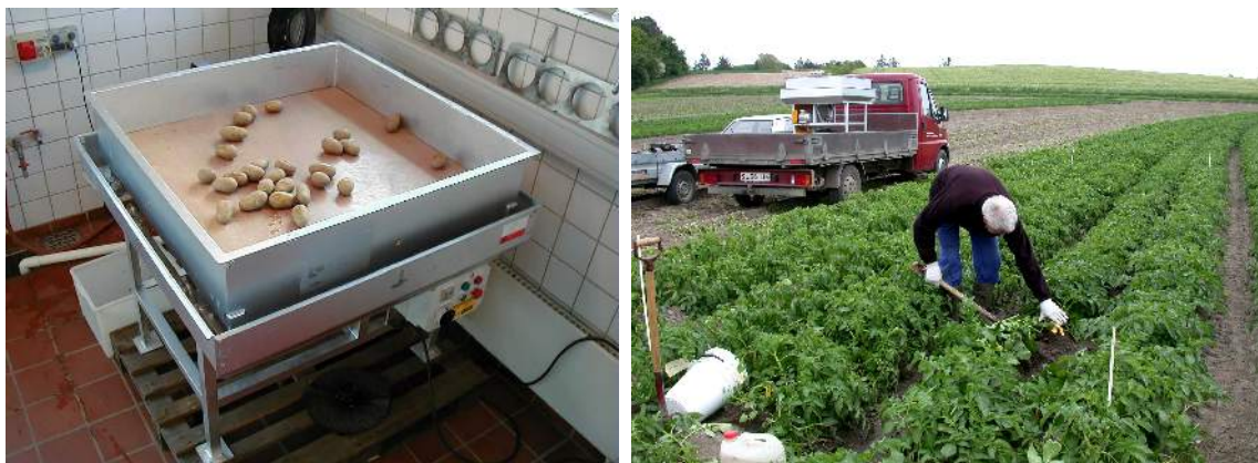
Figur 5. Billeder af rystebordet der har en træbund som bevæger sig vertikalt 3 cm med en frekvens på 290 slag i minuttet.
